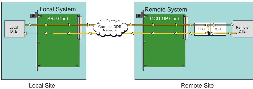
Figure 2-7. Inband Remote CSU Loopback
