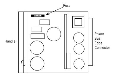
Figure 3-6. -48V Converter Fuse
