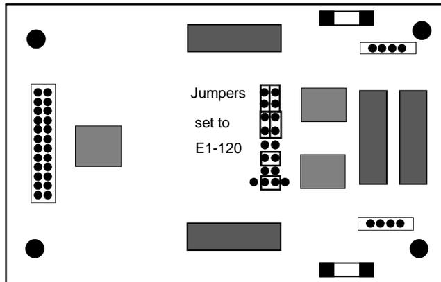
Figure 6-7. DSX/CEPT Module Jumpers (E1 120 Ohms)
