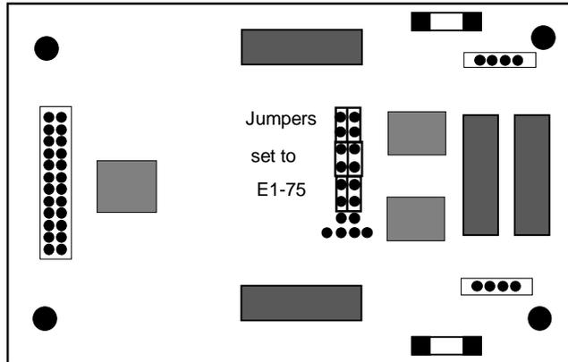
Figure 6-6. DSX/CEPT Module Jumpers (E1 75 Ohm)
