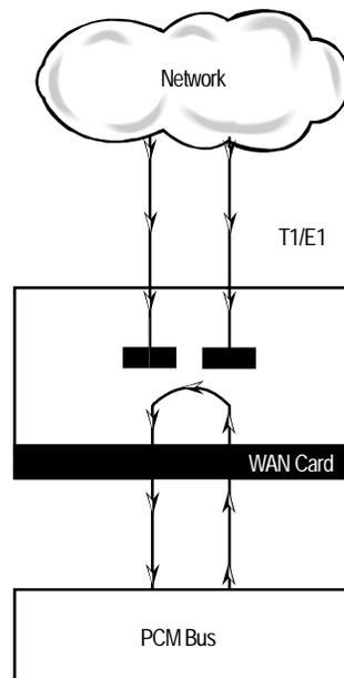
**Figure 6-22. DS0 Time Slot Loopback**
